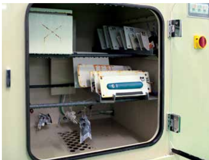
Cabina de pintado con polvo robotizada.
